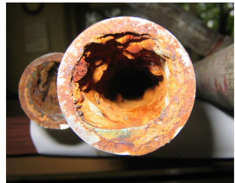
図1 40年を経た給水管の断面
