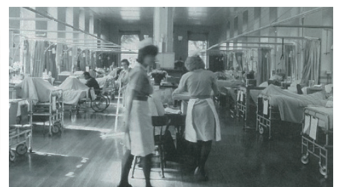
平面図・写真：ナイチンゲール病棟の天井の高い30床ワンルーム病室。(ロンドン 聖トーマス病院) 窓はベッドごとに設けられ、最上段の窓は換気のために常時オープン。ベッド間隔は1m以上を確保。 出典：ヨーロッパの病院建築 伊藤誠 丸善株式会社
